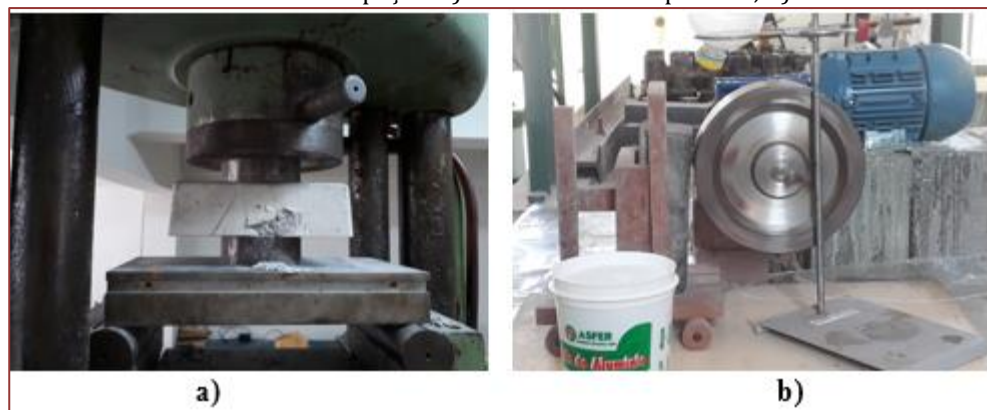
Figura 2 – Ensaio de resistência nas peças: a) resistência à compressão; b) resistência à abrasão.
