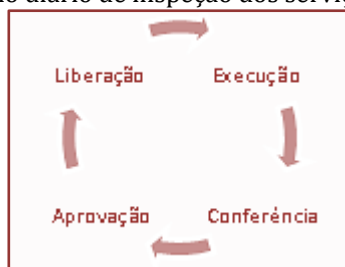
Figura 6: Ciclo diário de inspeção dos serviços executados.
