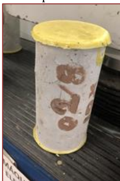
Figura 1 – Corpo de Prova Capeado
