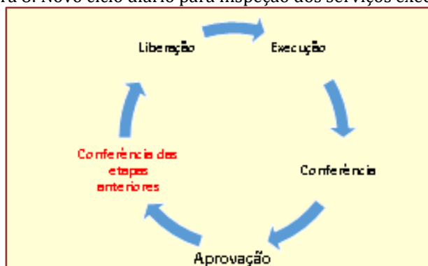
Figura 8: Novo ciclo diário para inspeção dos serviços executados.
