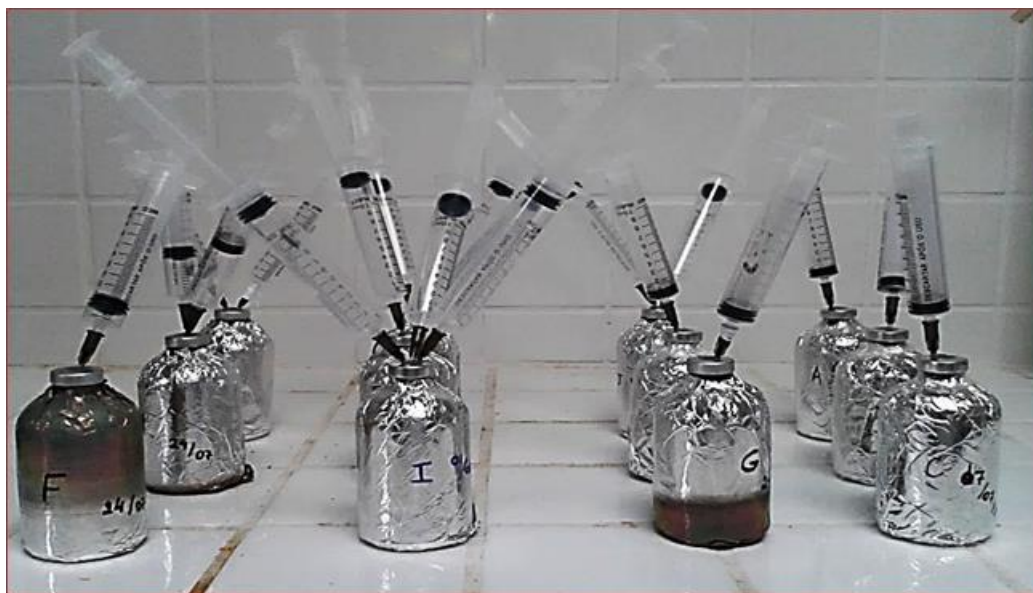
Figura 1: Sistemas de biodigestão anaeróbia em frascos de penicilina
