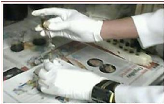
Figura 2 - Processo de filtração com filtros miliporosos
