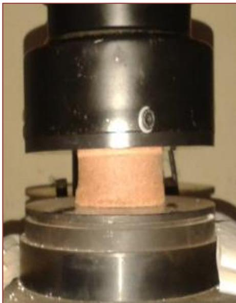
O briquete se rompeu sob uma carga de 1140 kgf (11,178 kN) e suportou uma tensão máxima de 2,75 MPa (28,0033 Kgf/cm<sup>2</sup>), conforme pode-se visualizar na figura 7.
