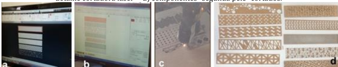
FIGURA3: a) paginação “segunda pele” em Autocad; b) aplicativo gerenciamento impressão laser; c) detalhe cortadora laser d) componentes “segunda pele” cortados.
