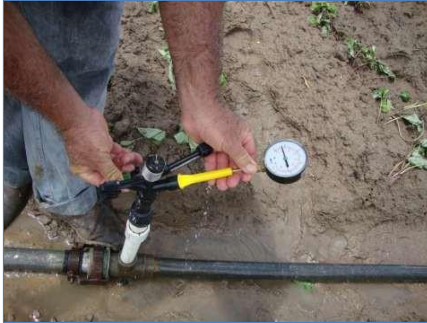
Figura 4. Medição da pressão de serviço do aspersor avaliado.
