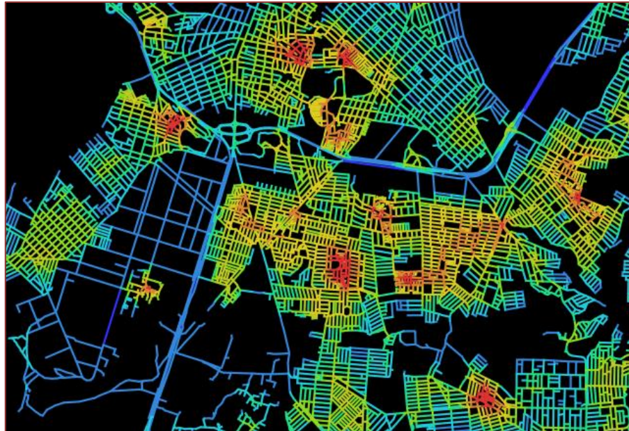
Figura 09: Mapa de integração, métrica de raio 400m. Cores mais quentes indicam espaços mais integrados, e cores mais frias indicam espaços mais segregados.
