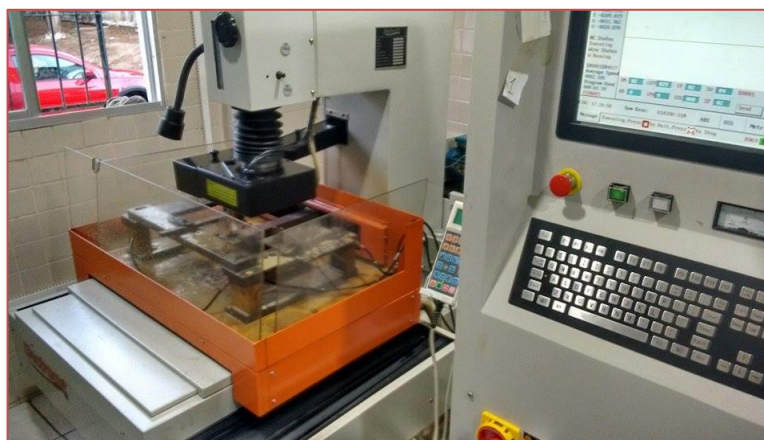
Figura 1: Processo de eletroerosão por penetração realizada na Universidade Federal de Campina Grande
