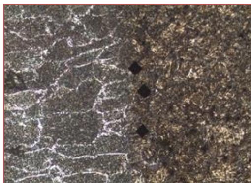
Figura 4. Microestrutura da região de ligação solda com Argônio (Autores, 2018)
