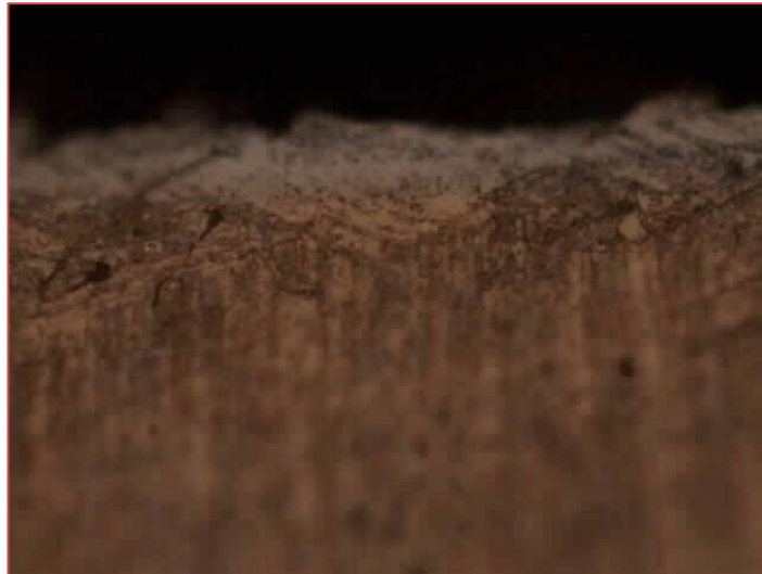
Figura 8: Perfil lateral de uma amostra da Classe C, antes do tratamento de nitretação.
