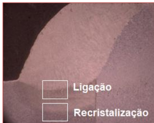
Figura 3. Secção da junta solda com Argônio (Autores, 2018)
