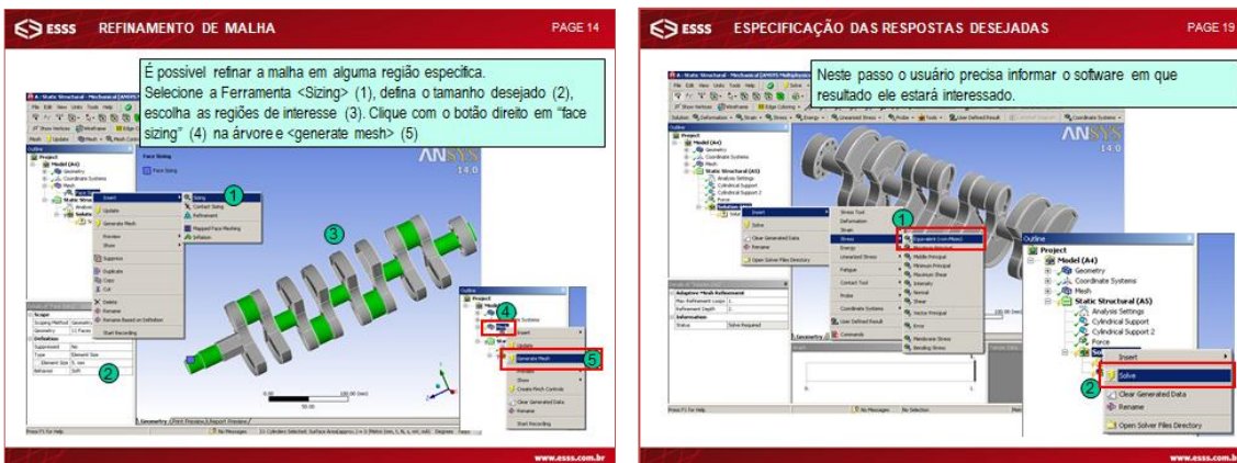
Figura 2 – Detalhe do tutorial passo a passo para o 1º exercício de Análise Estática Linear de um Virabrequim, refinamento da malha e pós-processamento de resultados.
