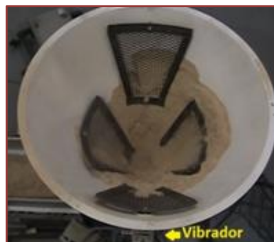
Figura 10: Telas rígidas acopladas a vibradores.
