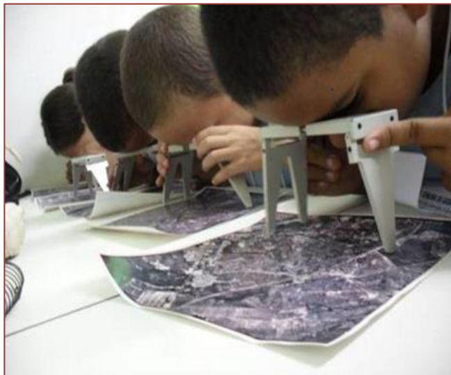
Figura 3 – Observação de fotos aéreas através do estereoscópio óptico utilizando a visão vertical.
