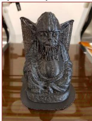
Figura 8 – Peça após acabamento e retirada dos suportes que são descartados.
