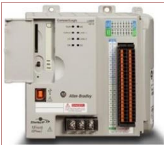
Figura 25 - CLP modelo CompactLogix5370 L2 da empresa Rockwell Automation.
