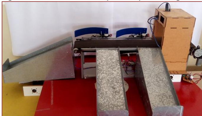
Figura 10: Sistema de classificação e seleção de mangas.
