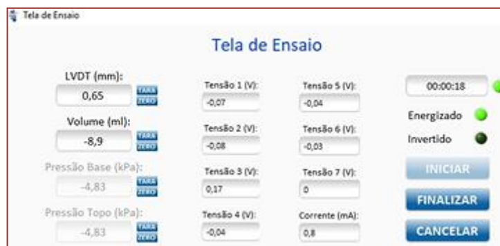
Figura 2: Sistema de supervisão de dados
