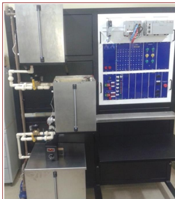
Figura 24 - Planta didática de controle de temperatura e nível de tanques.
