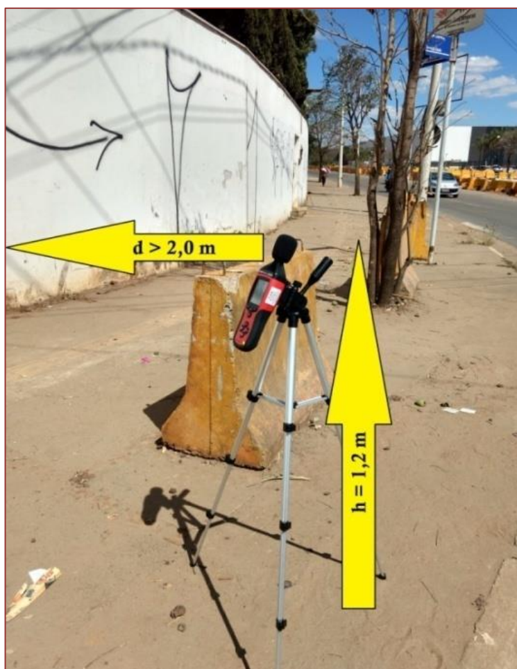
Figura 6 - Dimensões recomendadas pela ABNT para instalação do tripé com o medidor de nível sonoro inserido
