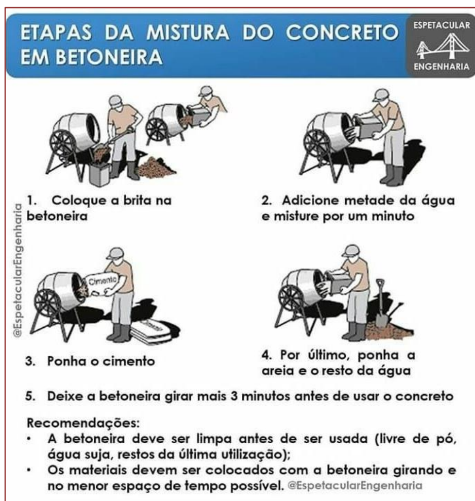
Figura 6: Etapas da mistura do concreto
