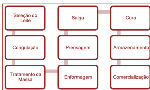
Figura 1: Esquema simplificado do processo de fabricação de queijos
