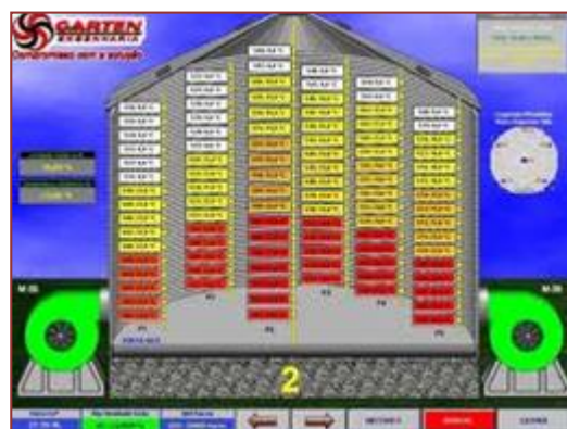
Figura 3 - Silo com cabos de controle para medição da temperatura
