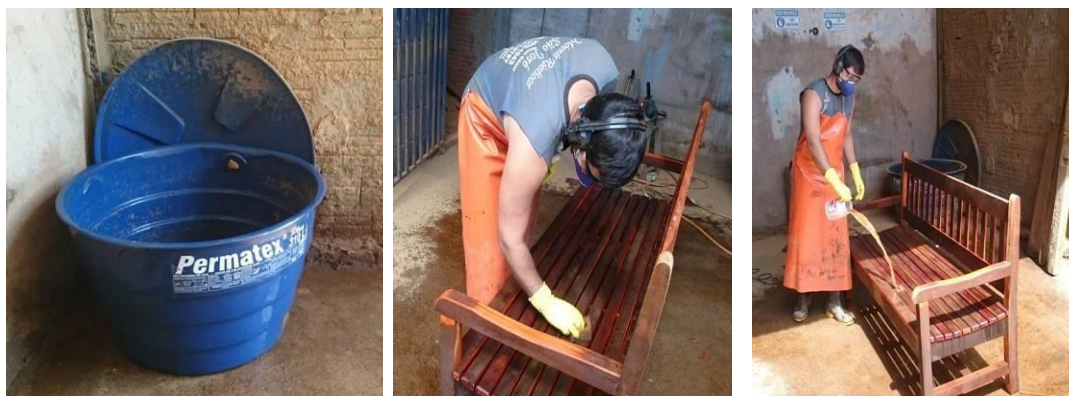
Figura 10- Aplicação da Soda Antes (direita) e depois (centro) da P+L e caixa d'água para diluição em maior quantidade (esquerda)
