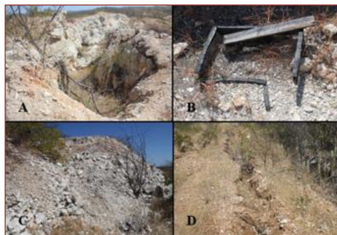
Figura 7: Impactos ambientais identificados no garimpo Lagoa do André 2. (A) Risco de desmoronamento dos taludes; (B) Lixo depositado aleatoriamente; (C) Pilhas de estéril e (D) Processos erosivos.
