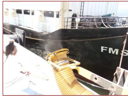
Figuras 9 e 10: Nebulizador “Dumbo” em operação no Porto de São Sebastião
