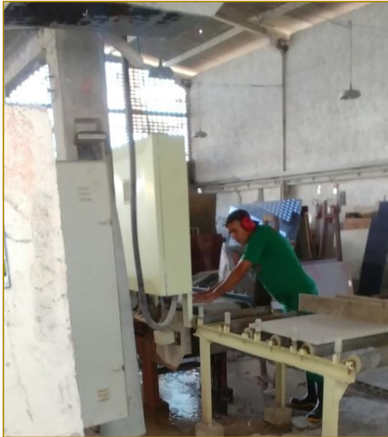
FIGURA 4 – Processo de corte realizado na marmoraria estudada.
