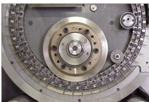
Figura 03: Processo de estampagem da cabeça do prego
