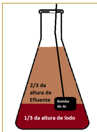
Figura 1: Esquematização do Reator Aeróbio
