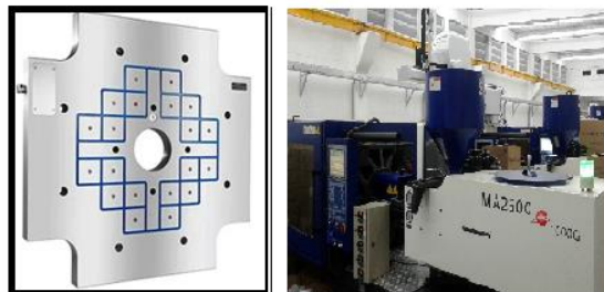
Figura 7. Modelo de Placa Magnética e Máquina Injetora utilizada (Haitan).
