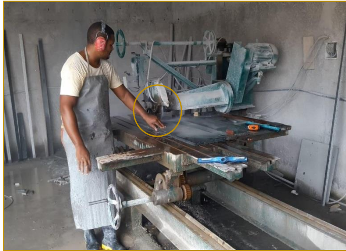
Figura 08: Colaborador utilizando a serra grande de maneira incorreta
