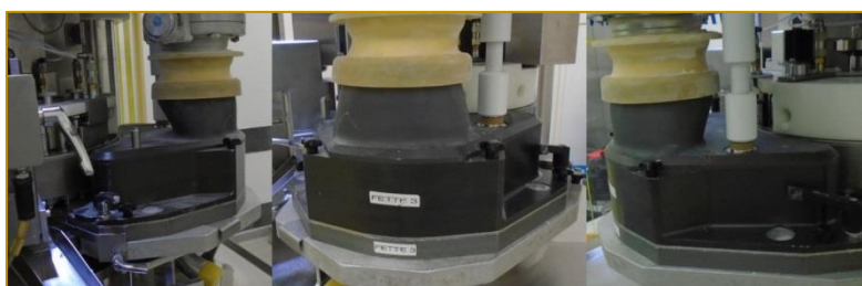
Figura 4 – Conjunto fill-o-matic (vistas lateral e frontal)
