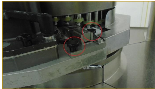
Figura 6 – Manípulos utilizados para padronizar parafusos
