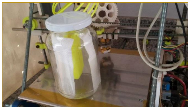
Figura 3 – Processo de tratamento superficial do ABS
