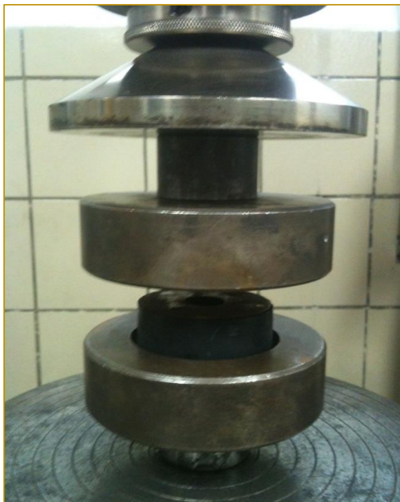
Figura 7: Configuração da máquina de teste de compressão.
