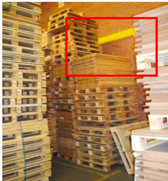
Figura 2: Pallet /tampa desativado ultrapassando margem de segurança
