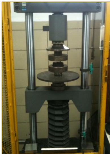
Figura 6: Configuração da máquina de teste de compressão.
