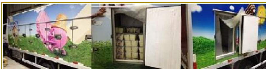
Figura 7 – Caminhão, suas divisórias e cortinas de PVC.
