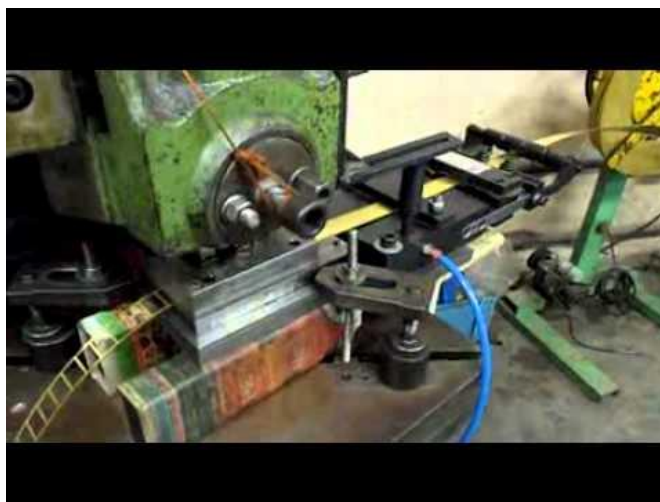
Figura 2. Prensa excêntrica adaptada com alimentador e desembobinador, possível solução do projeto.
