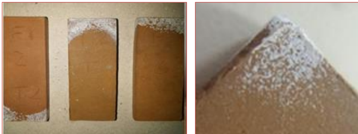
Figuras 3 e 4. Formação de eflorescências nos corpos de prova com o rejeito pó de despoeiramento.
