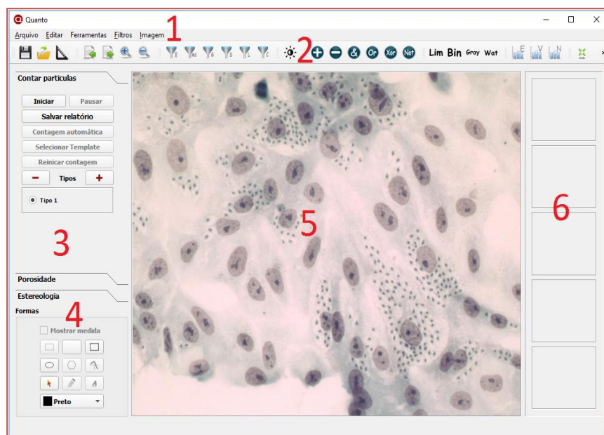
Figura 2. - Interface gráfica do Quanto. 1) barra de menu; 2) caixas de ferramentas; 3) painel lateral de funcionalidades; 4) ferramentas de criação de formas; 5) área de trabalho; 6) painel de snapshot.
