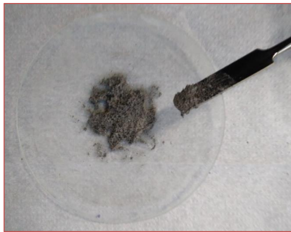
Figura 7 - Mistura do compósito de matriz poliéster com 40% de Al em volume.
