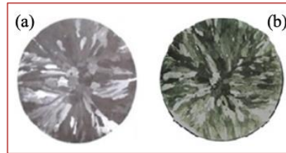
Figura 2 – (a) e (b) Macrografia da liga Al-0,05%Cu-[0,35-0,45]% Fe-0,22% Zr STT e TT 150°C/4h, respectivamente.
