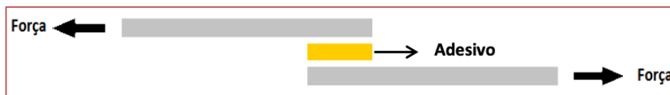
Figura 5 - Modelo do ensaio de cisalhamento em uma Single-Lap-Joint.
