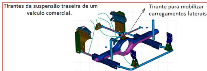
Figura 5 – Conjunto de suspensão pneumática aplicada a um veículo comercial.
